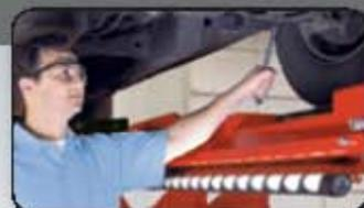
**➤ Подсветка на подъёмнике включается автоматически при поднятии на высоту проведения развал-схождения.**
